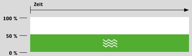
Lineare Leistungssteuerung bei neuer Mikrowellen-Invertertechnik. Beispiel: 50 % Leistung (ca. 450 Watt)
